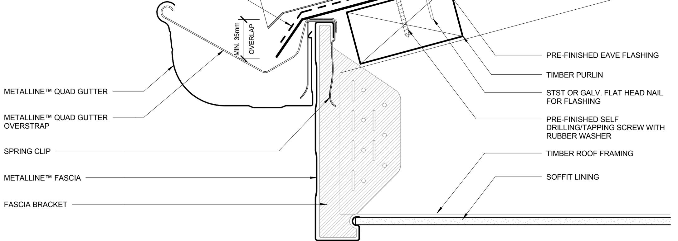
METALLINE™ QUAD GUTTER
