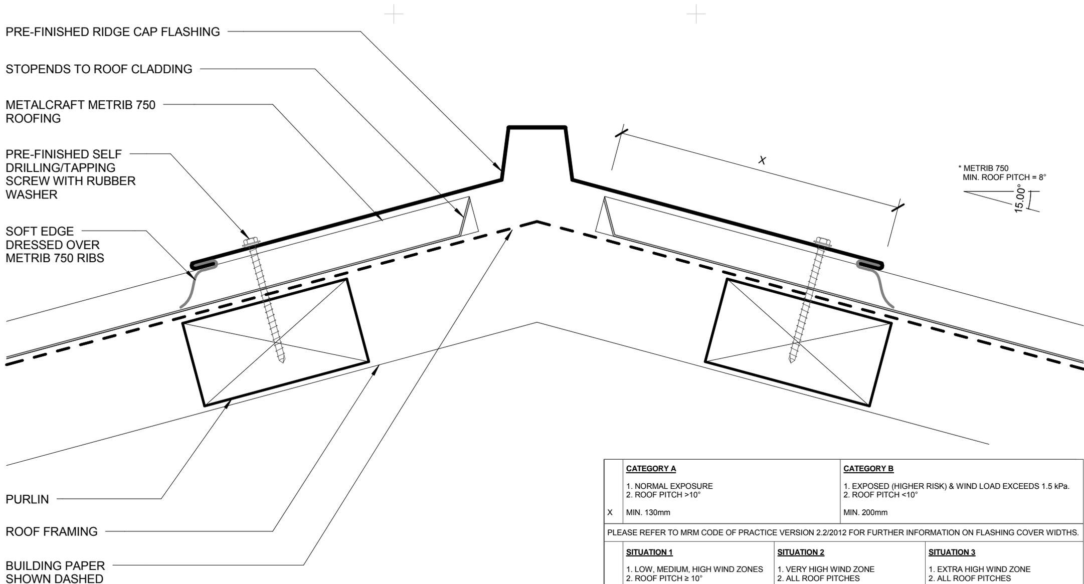
PRE-FINISHED RIDGE CAP FLASHING
